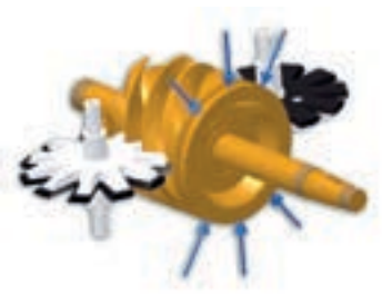
Charges radiales intervenant sur les parties supérieure et inférieure du rotor principal.
