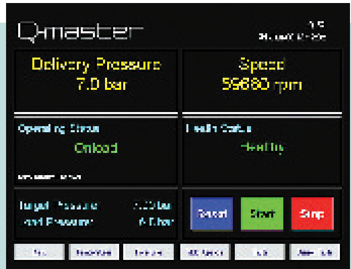
Der Kompressorbetrieb wird durch das intelligente Steuer- und Regelungssystem Q-Master überwacht
